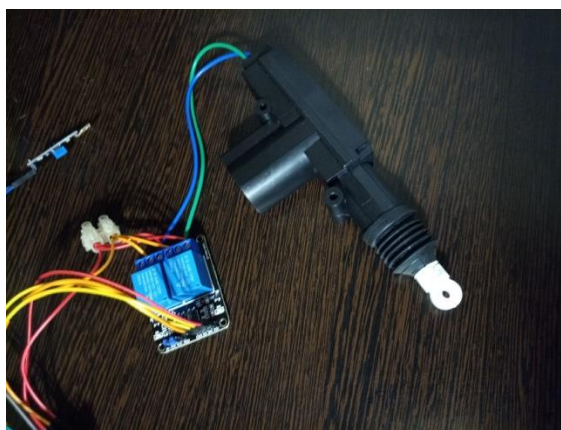
Рисунок 26. Подключения электропривода на прямую к реле
