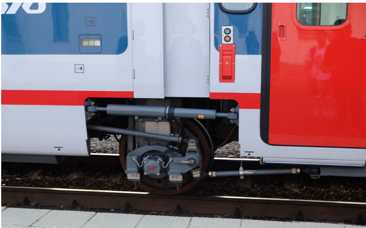
Обратите внимание на то, что колеса расположены практически между вагонами Поезд идет очень плавно.
