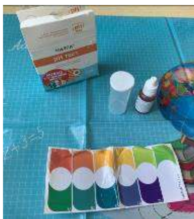
Фото 4 Индикатор для измерения уровня pH воды в аквариуме
