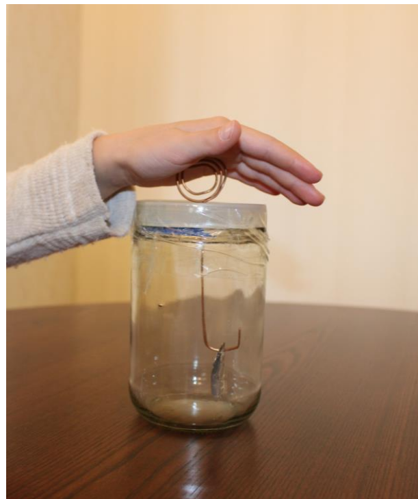
Рисунок 2 – Разряжаем электроскоп, касаясь проволоки рукой
