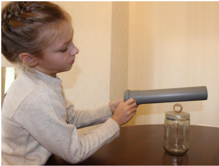
Рисунок 1 – Заряжаем электроскоп пластиковой трубкой, имеющей отрицательный заряд
