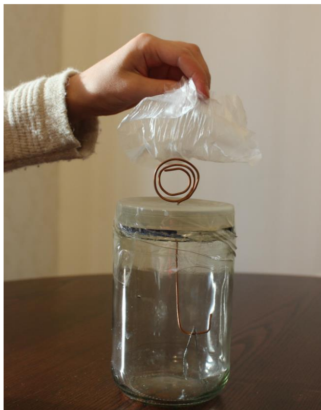
Рисунок 4 – Подносим к заряженному пластиковой трубкой электроскопу наэлектризованный полиэтиленовый пакет
