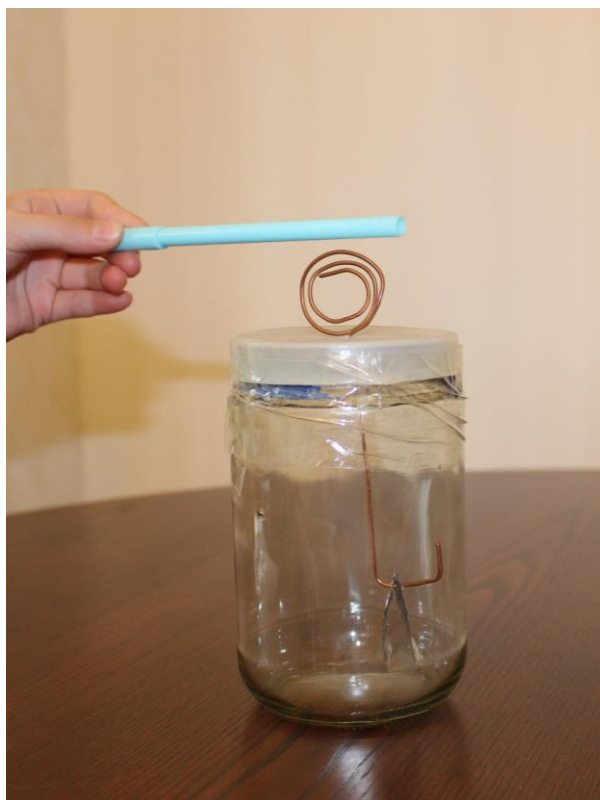
Рисунок 5 – Подносим к заряженному пластиковой трубкой электроскопу наэлектризованный фломастер
