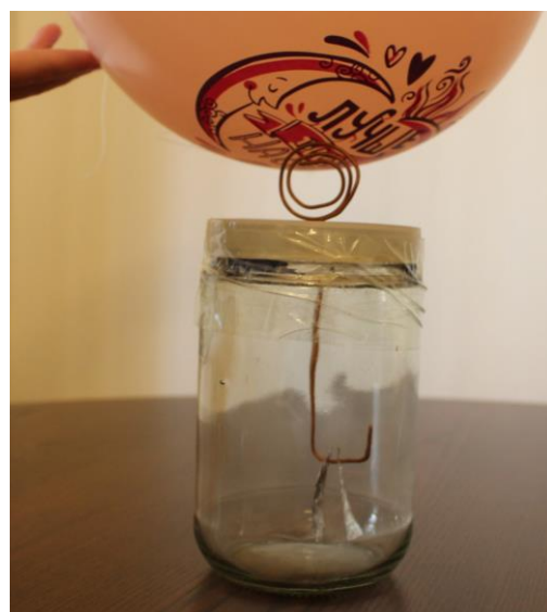
Рисунок 3 – Подносим к заряженному пластиковой трубкой электроскопу наэлектризованный резиновый шарик
