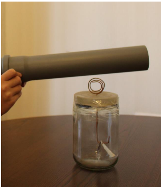
Рисунок 1 – Заряжаем электроскоп пластиковой трубой
