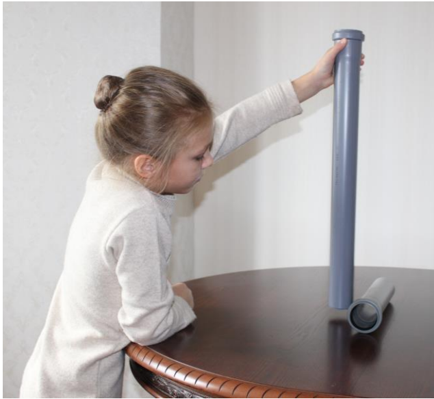
Рисунок 1 – Наэлектризованные пластиковые трубы имеют заряд одного знака и отталкиваются
