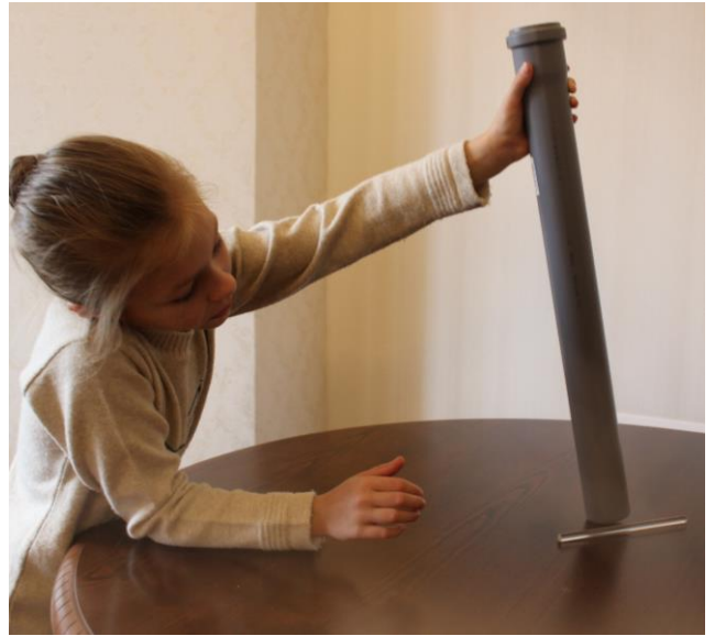
Рисунок 2 – Наэлектризованная стеклянная палочка имеет заряд противоположный по знаку заряду пластиковой трубы и притягивается к ней
