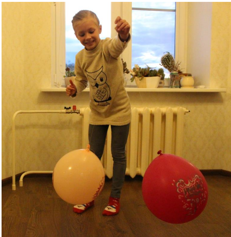
Рисунок 1 – Шарики, получившие при электризации заряд одного знака, отталкиваются
