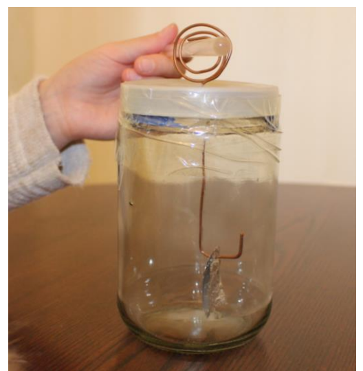
Рисунок 2 – Подносим к заряженному электроскопу стеклянную палочку, имеющую положительный заряд
