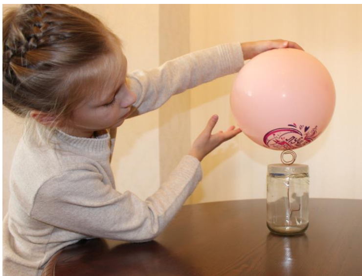
Рисунок 3 – Подносим к заряженному пластиковой трубкой электроскопу наэлектризованный резиновый шарик
