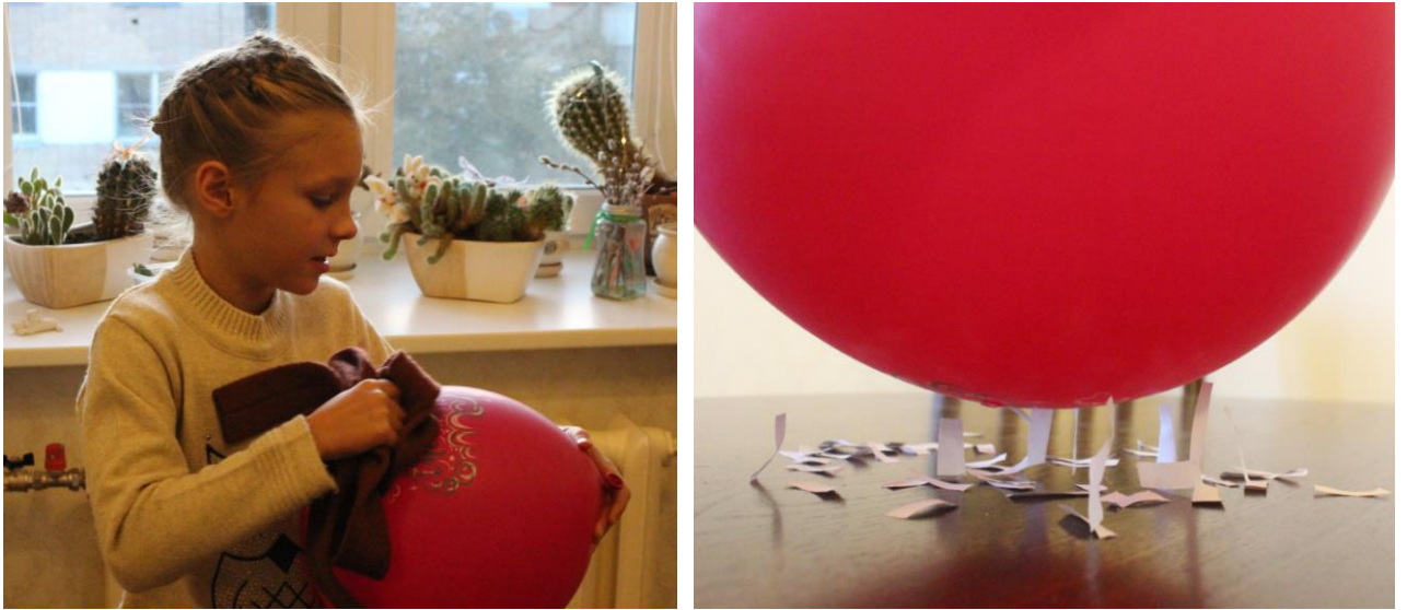
Рисунок 1 – Наэлектризованный шарик притягивает кусочки бумаги
