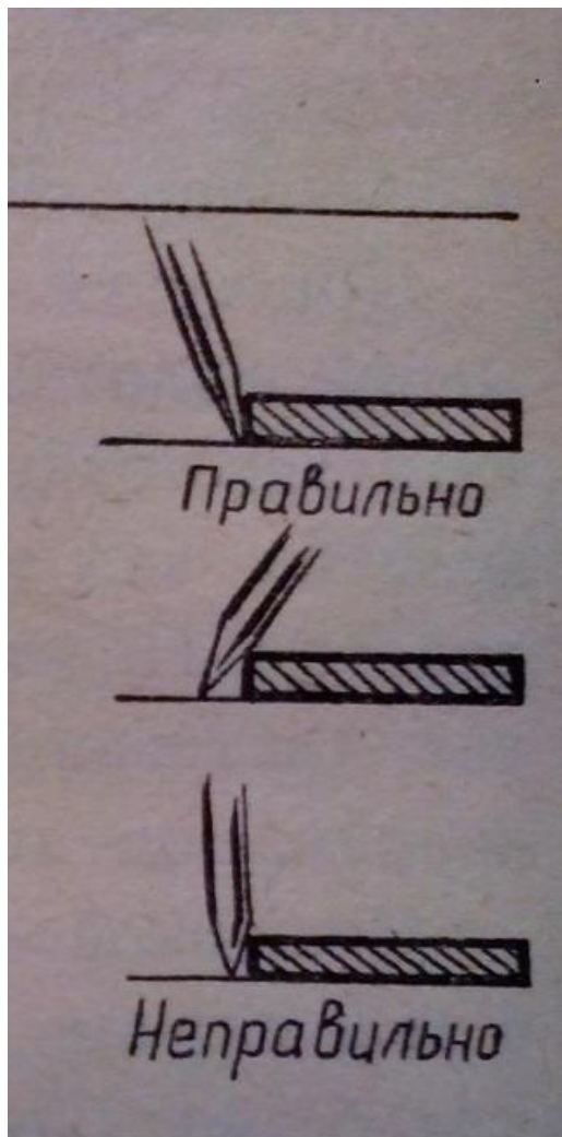
В Правильное и неправильное положение чертилки
