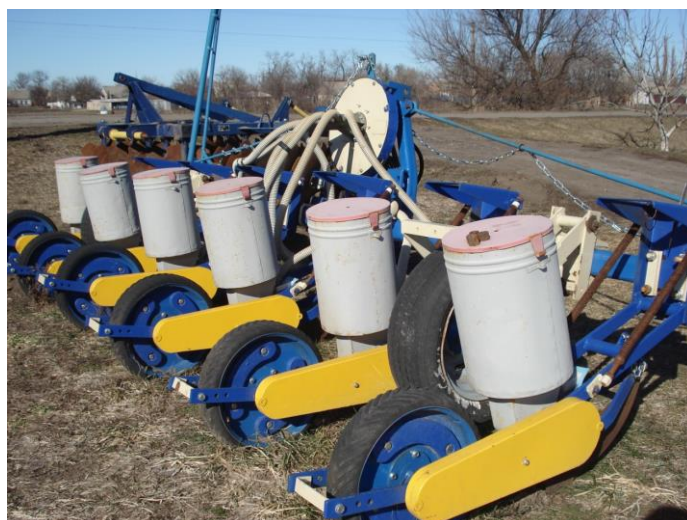
Рисунок 2 – Свекловичная тракторная сеялка ССТ-12А
