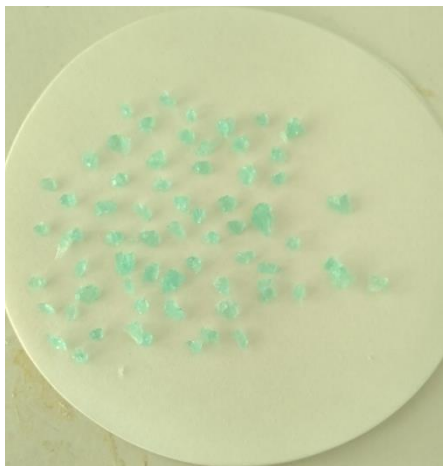
Рисунок 4. Выбирание затравки основного кристалла на нити .
