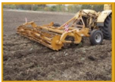
Трактор везет за собой плуг - рыхлитель земли. Он переворачивает верхний слой почвы.
